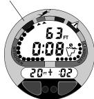
Fig. 50 - Decompression Mode (entering into)
